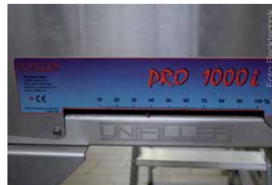
Bild links: Die runden Formen werden von einem Fotosensor erkannt, in den Gates fixiert und mit der entsprechenden Menge an Masse gefüllt. Bild Mitte: Die Erweiterung der Anlage mit einer zweiten Dosierstation wäre denkbar, damit weitere Schritte automatisiert werden können. Bild rechts: Die Einwaage kann über Volumen in Prozent und die Stärke des Zylinders verändert werden.
