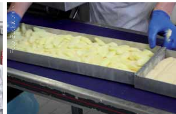
Bild links: Die Hebe-Senk-Düse ist auf die Breite des Bleches abgestimmt und füllt die Masse sehr gleichmäßig in die Form ein. Bild Mitte: Abteilungsleiter Jens Dose (links) und Thomas Dreller sind für die Abläufe an der Dosieranlage zuständig. Bild rechts: Die Masse hat sich schnell und gleichmäßig auf dem Blech verteilt, so dass ein weiteres Verstreichen entfällt und sofort mit dem Belegen begonnen werden kann.
