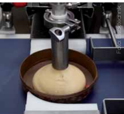
Bild links: Die runden Formen werden von einem Fotosensor erkannt, in den Gates fixiert und mit der entsprechenden Menge an Masse gefüllt. Bild Mitte: Die Erweiterung der Anlage mit einer zweiten Dosierstation wäre denkbar, damit weitere Schritte automatisiert werden können. Bild rechts: Die Einwaage kann über Volumen in Prozent und die Stärke des Zylinders verändert werden.
