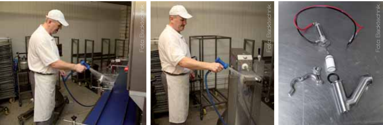
Bilder links und Mitte: Sowohl die Bandanlage mit Steuerung als auch die Dosiermaschine lassen sich im Nassraum mit einer Handbrause reinigen. Bild rechts: Die einzelnen Komponenten lassen sich ohne Werkzeug auseinanderbauen, um sie dann unter Wasser reinigen zu können.
