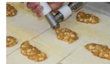
Nachdem auf die mit der Schneidewalze eingeteilten Teigstücke mit dem Unifiller die Apfelfüllung aufgetragen ist, können die Teiglinge gefaltet und auf Bleche gesetzt werden. Das Dosiergerät gewährleistet eine einheitliche und reproduzierbare Gebäckqualität, denn jeder „Apfeltraum“ enthält jetzt immer genau die richtige Menge Füllung.
