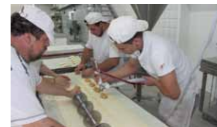
Nachdem auf die mit der Schneidewalze eingeteilten Teigstücke mit dem Unifiller die Apfelfüllung aufgetragen ist, können die Teiglinge gefaltet und auf Bleche gesetzt werden. Das Dosiergerät gewährleistet eine einheitliche und reproduzierbare Gebäckqualität, denn jeder „Apfeltraum“ enthält jetzt immer genau die richtige Menge Füllung.
